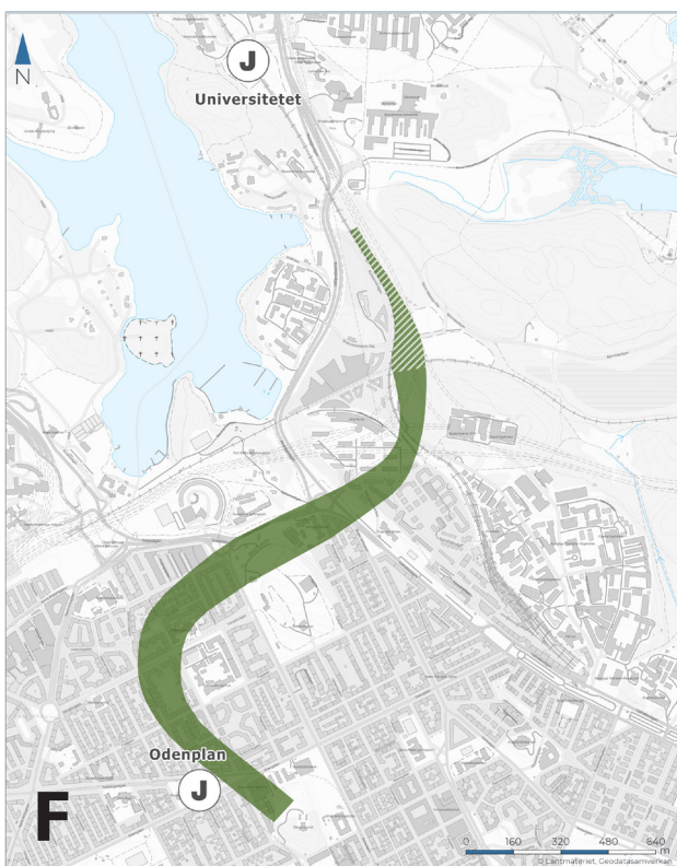
Ansluter till befintlig Roslagsbana norr om Albano för att gå under jord i tunnel via ett tråg och betongtunnel. Alternativet passerar nära Värtabanan och några av Norra länkens tunnlar.
